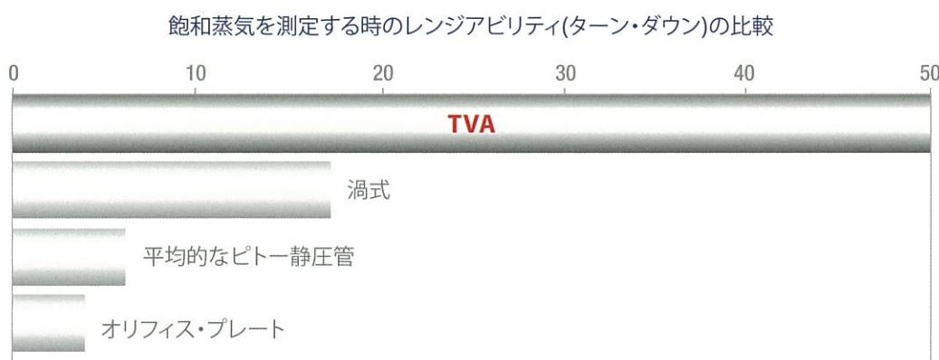
一般的な差圧式流量計は、差圧を開平演算して流量出力とするため、少ない流量を測定する能力が問題になります。また、渦式の場合、流量が少ないと十分な渦が発生しないので、計測できません。従って、蒸気は測定されないまま消費され続けることになります。
